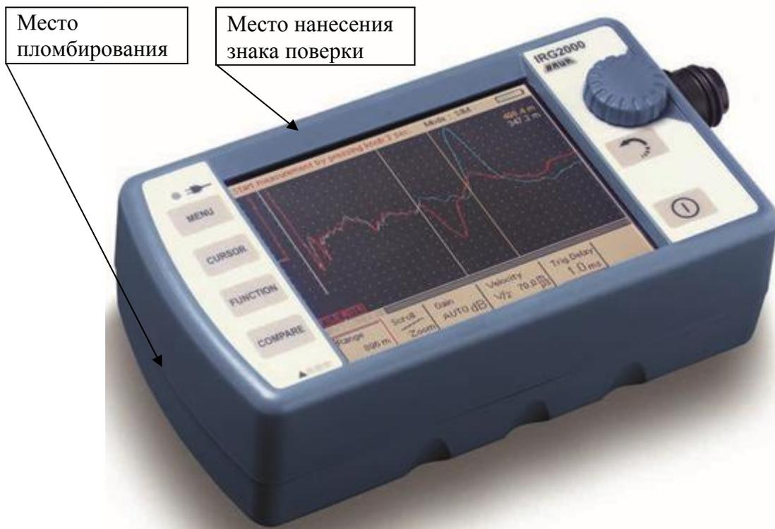
Рисунок 1 – Общий вид рефлектометров импульсных IRG 2000
