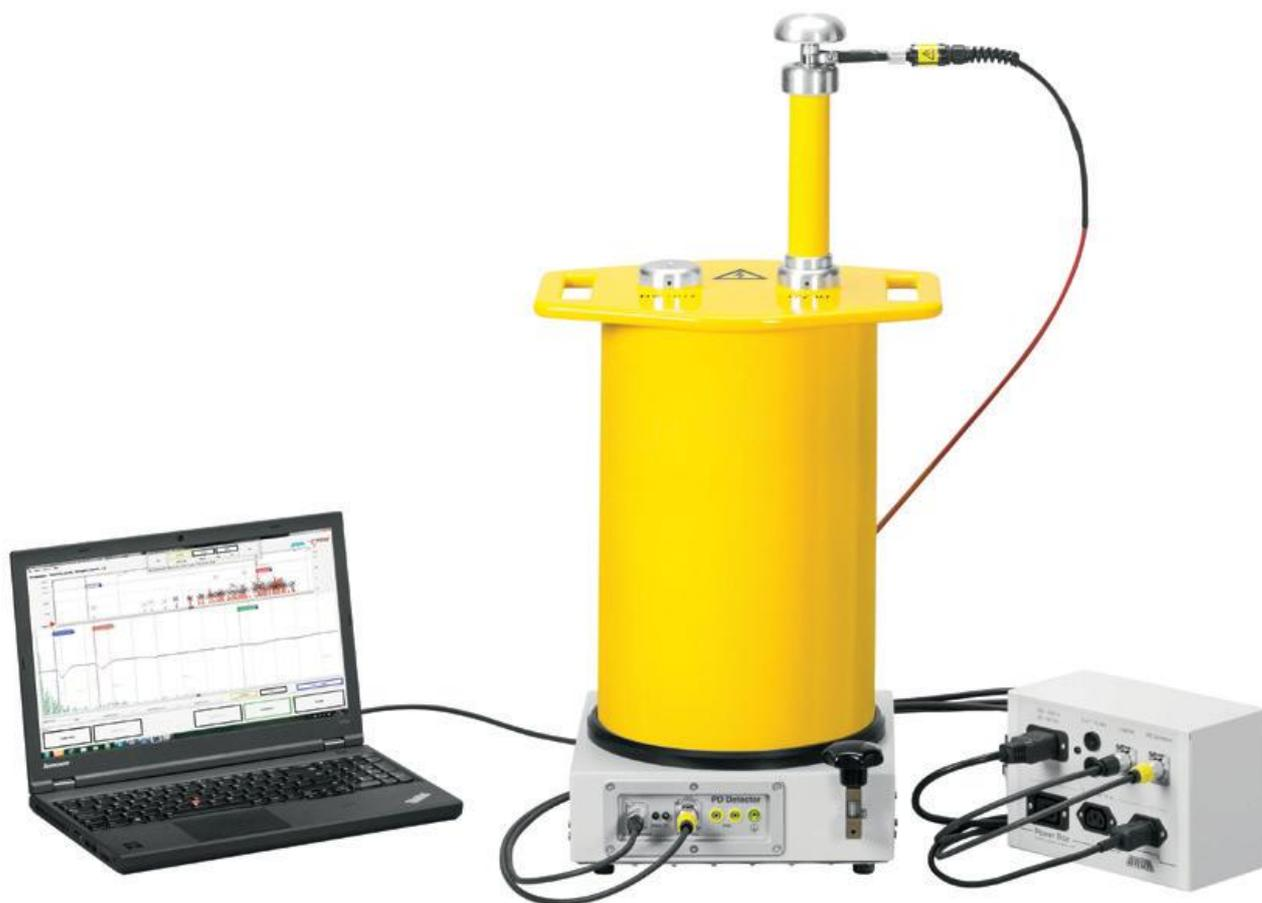
Рисунок 2 – Общий вид систем PD-TaD 80
