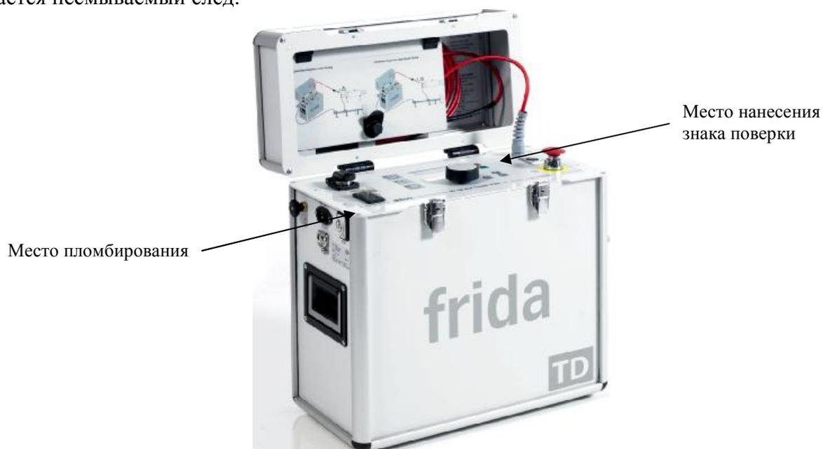
Рисунок 1 – Внешний вид генераторов высоковольтных инфранизкочастотных Frida TD
